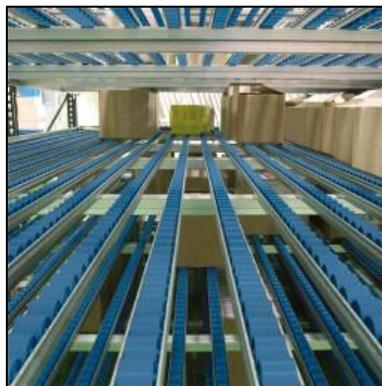
*Módulos provistos por ruedas y/o módulos estáticos. Puede almacenar varias cajas de frente, fondo, y alto sobre rieles con rodamientos, consiguiendo que la rotación de los productos sea primeras entradas primeras salidas.*
