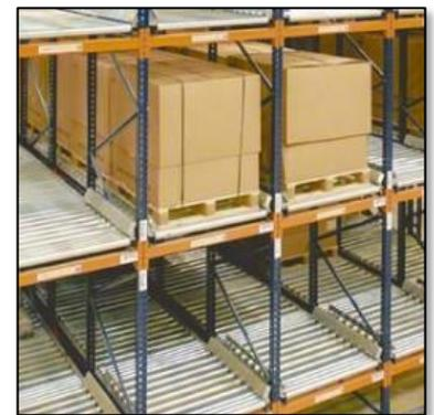
*Los rodillos permite el deslizamiento de las tarimas sobre éstos. Las tarimas se introducen por el extremo más alto de los caminos y se desplazan, por gravedad y a velocidad controlada, hasta el extremo contrario, quedando dispuestas para su extracción.*
