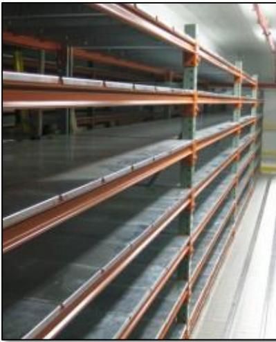
*Este sistema se utiliza para almacenar cargas medias. Los paneles (metálicos o madera) Hay travesaños disponibles para aumentar la capacidad de carga.*
