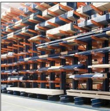
*Es un sistema que está diseñado para almacenar cargas largas y/o voluminosas en tómanos no uniformes, que usualmente son cargadas lateralmente ya que no cuenta con ningún material que limite el uso de espacio horizontal.*
